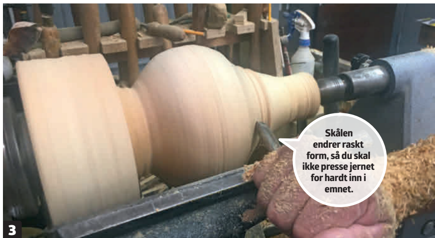
3 Form skålen slik du ønsker at den skal se ut. Vi vil gjerne ha den til å være forholdsvis rund. Derfor fjerner vi en del tre i både toppen og bunnen av skålen. Jo mer tre du fjerner i bunnen, desto "lettere" uttrykk får skålen.
