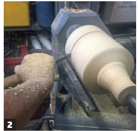
2 Marker bunnen på skålen, slik at du har oversikt over hvor mye tre du har å jobbe med. Når størrelsen på skålen er definert, er det enklere å gjøre seg tanker om formen.
