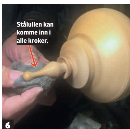
6 Slip knoppen med stålull. Fordelen med stålull er at du kan komme til i alle kroker, samtidig som du nesten ikke fjerner noe tre. Bruker du derimot sandpapir, kan du fort komme til å endre på formen.
