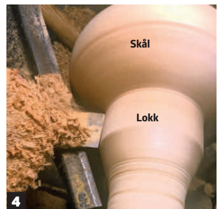
4 Legg en skrå meisel til rette på anlegget, og bestem diameteren på lokket. Det er viktig at "kanten" på lokket blir helt rett for at det skal kunne sitte helt tett.
