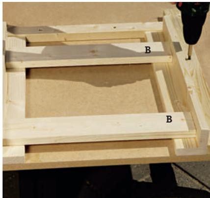
**5** Legg ut de to beina (A + D) med et par sidebord (B) imellom. Skru fast ei list til arbeidsplata på hver side av beina – så har du ei fast form som du kan bruke når du lager de andre sidene.
