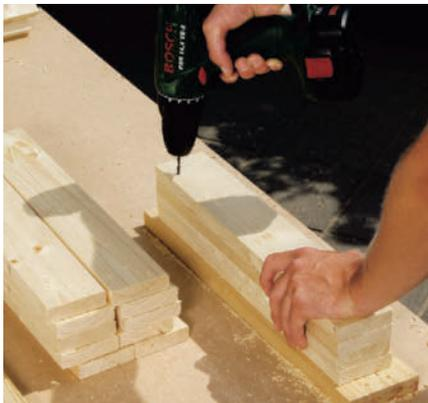
**4** Legg fire sidebord oppå hverandre – da sparer du tid når du skal bore ut til skruhullene fordi du kan utføre arbeidet i en operasjon. Du skal bruke et 4 mm bor til hullene.
