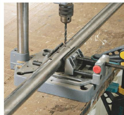
**6** I stålstanga bores 6,5 mm hull som vinkelbeslagene kan festes i. Plasseringen av hullene er vist på tegningen på neste side (bor gjerne ekstra hull slik at du senere kan endre plasseringen av de store skivene hvis du får bruk for det).
