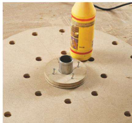
**3** Bruk et stykke av stålstanga som mal når du skal feste styreskivene på oversiden på de store skivene. Lim og skru fast de små skivene med fire 4 x 35 mm skruer. Bor opp til skruene først.
