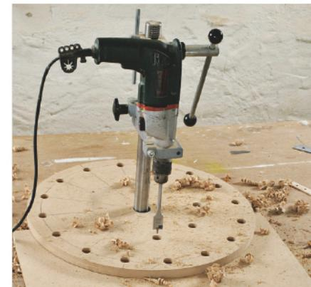
**5** Bruk hullet i midten av skiva som sentrum for borestativet når du skal bore den innerste rekka med hull med et 22 mm flatbor. Dybdestoppen sikrer at alle hullene blir nøyaktig 15 mm dype.
