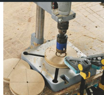
**2** Nøyaktig i sentrum borer du et hull med ei 41 mm hullsag. Pass på å spenne fast skivene med tvinger på plata på borestativet, og bor fra begge sider. Slip lett i hullet du har boret.
