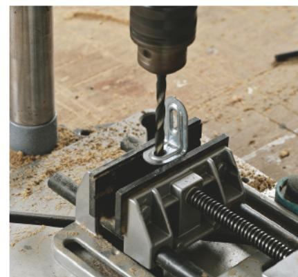
**4** Hver bæreskive utstyres med to små vinkeljern (seks i alt). Skruhullet på hvert vinkeljern bores ut slik at diameteren blir 6,5 mm. De lange hullene på vinkeljernene skal være som de er.
