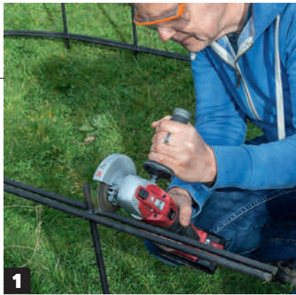
1 Leikkaa ruusukaari sopivan pituiseksi alapäästä kulmahiomakoneella. Leikattu pää kannattaa maalata, jotta se ei ruostu.
