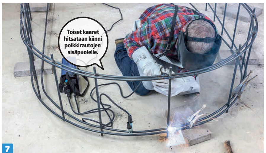
7 Hitsaa poikkiraudat kiinni toisesta päästä. Molemmille puolille hitsataan kiinni toiset kaaret, jotta ruusukaaresta tulee tukeva.
