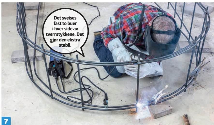
7 Sveis fast tverrstykkene til en bue i motsatt side. På begge sider sveises det også fast en bue på innsiden av tverrstykkene, slik at det reelt er en dobbeltbue.
