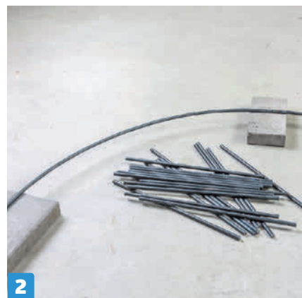
2 Plasser en bue på et par steiner, slik at den er hevet litt over gulvet. Her er det 3 cm, som blir den avstanden tverrstykkene stikker utenfor buen når de er sveiset fast.
