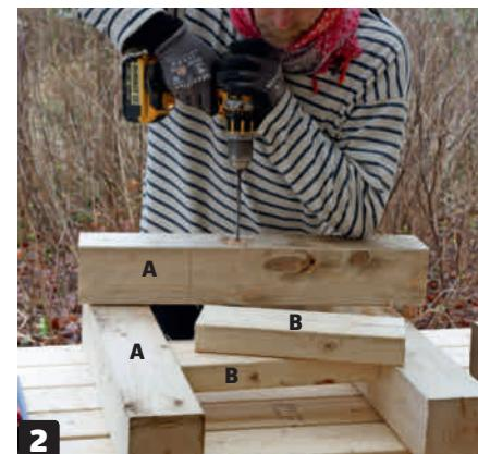
**Det forbores i beina (A) til vangene (B og C)**, som er kappet til på kappsgrenen. Vangenes underkant settes 41 cm fra beinas underkant. Hullene borer med et 5 mm bor og undersenes med et 10 mm bor.
