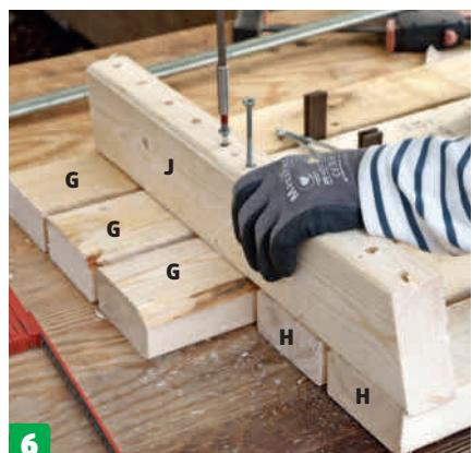
**Rammestykken (J) skrus fast** bak på rygglenet med de korte skruene. De to nederste stykkene av rygglenet (H) er kortere enn de øverste (G), og skal flyttes inn så de flukter med rammestykket.
