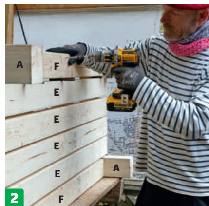
2 Fastgør sædets yderste reglar (F) – dem, der er placeret mellem benene (A) – til de lange vanger. Her får de hver tre lange skruer, der sættes i midten og i hver side.
