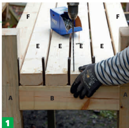
1 De fire midterste lange reglar (E) til sædet skrues fast med lange skruer til de korte vanger (B). Der placeres to 5-mm-afstandsklodser mellem reglarne, så mellemrummene har samme størrelse.
