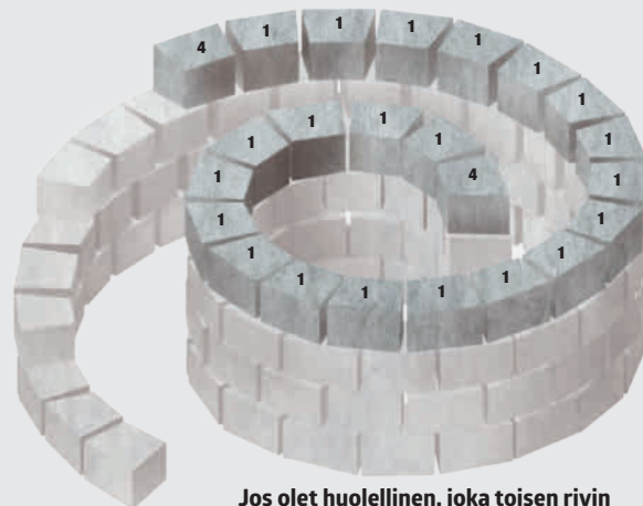
Jos olet huolellinen, joka toisen rivin saumat osuvat toistensa kohdalle.
