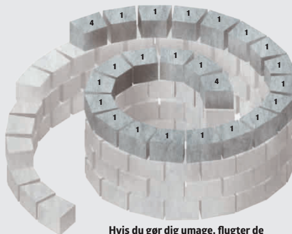
Hvis du gør dig umage, flugter de lodrette fuger i hvert andet lag.
