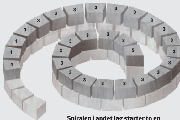
Spiralen i andet lag starter to og en halv sten inde på første lag.
