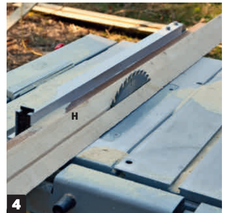
4 Skjær av ca 1,5 cm på trekantlistene (H), slik at den ene 45-graders vinkelen reduseres.
