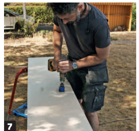
7 Sahaa kansi. Säilytystilan kansi tehdään vanerista, johon porataan kaksi kädensijaa 54 millin reikäsahalla.
