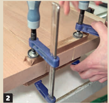
1 Vi limer tre stykker træ sammen til ben. For at få benene i de rigtige mål sætter vi flere stykker træ sammen. Smør limen på fladerne med en pensel.
