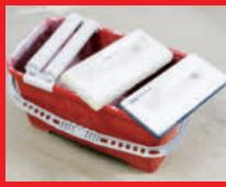
Det er en fordel å ha et flisfugesett som består av et spann med rulle, en flissvamp med håndtak og et gummibrett med håndtak. Rullene på spannet gjør det enkelt å presse ut det meste av vannet fra svampe.
