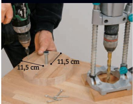
**1** Legg en rundning på den nederste benkeplata med sentrum 11,5 cm fra kanten, og bør et 12 mm hull midt gjennom rundingen og benkeplata. Skru den fast med fire skruer. Gjenta ved den mellomste plata.
