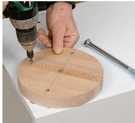
**3** Montér nå en av rundingene på skapet, helt ut til kanten. Først med fire skruer ovenfra, deretter med fire skruer nedenfra.
