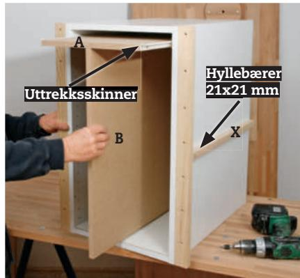
**4 Montér innmatten i skapene** på uttrekksskinne. Her består den av ei T-hylle og ei E-hylle som du monterer først med lim og skruer. Avslutt med ei list (X) som skal bære hyllene på høyre og venstre side av hvert skap.
