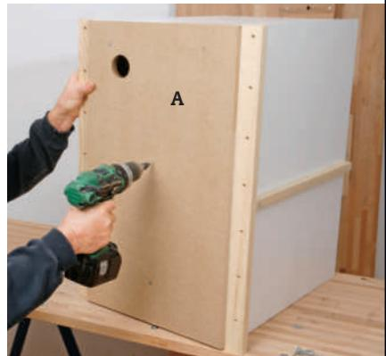
**5 Skru fast dørene (A)** på uttrekks-hyllene utenfra. Gripehullene er sagt med ei 50 mm hullsag.
