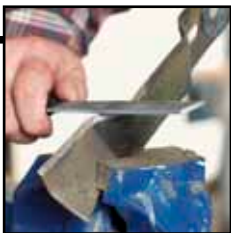
Fil først kniveggen jevn med en flatfil.
