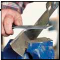
Fil først kniveggen jevn med en flatfil.
