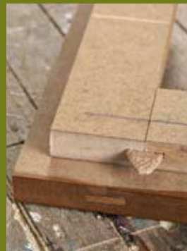
Jos lamelli on liian iso, ylijäämä voidaan leikata pois liiman kuivuttua.
