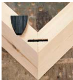
Erikoislamelliliuskalla koottu kulmaliitos. Lue lisää seuraavalta aukeamalta.
