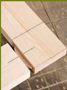
Rettvinklet hjørnesammenføyning der det akkurat er plass til «fisken».
