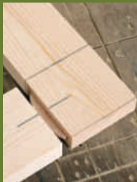
Retvinklet hjørnesamling, hvor der lige akkurat er plads til fisken.
