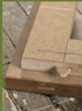
Er fisken for stor, kan det overskydende skæres af, når limen er tør.
