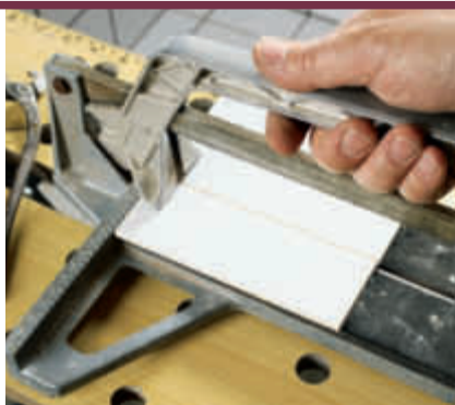
Kovemmissa laatoissa kahva siirretään laatan keskelle laatan taittamiseksi.
