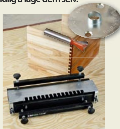
Settet består av et sammenspenningsanlegg med mal (sinkekam), en kopiring, og et sinkefresestål.
