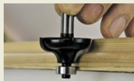
Hit og ikke lenger; kulelagerstyringen kan ikke sitte lenger nede uten å miste taket på emnet.
