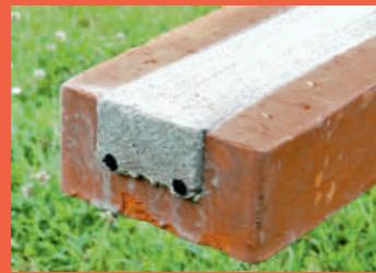
**STÅLTEGLET MURES IND OVER MURHULLET** og flytter på den måde vægten ud på den omgivende mur. Ståltagler er en række mursten med indstøbte armeringsjern.
