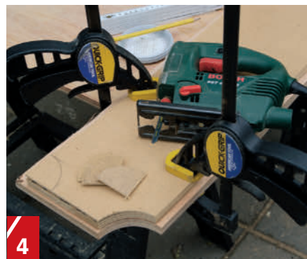
4 Rita formen på dekoren. Här formas hörnen efter en burk. Dekorskiivorna spänns fast på en stump plywood och sågas ut på en gång med en elektrisk sticksåg.
