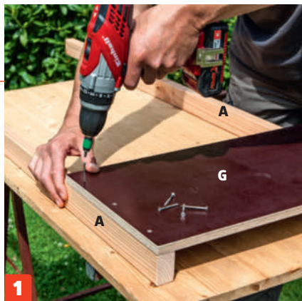
1 Ruuvaa taustalevyt (G) kiinni jalkoihin (A) aiemmin porattujen reikien läpi. Kiinnitä levyt 4x50 millin ruuveilla. Rakenna aluksi korkein osa, jossa on kaksi laatikkoa.
