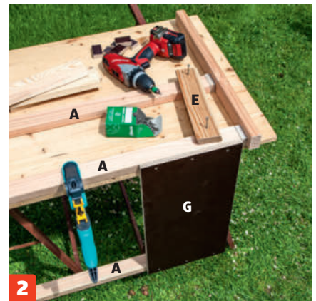
2 Kiinnitä taustalevy ja jalat väliaikaisesti työpöytään ja ruuvaa kiinni rimat (E) 3,5x40 millin ruuveilla. Varmista, että osat ovat suorassa kulmassa toisiinsa nähden.
