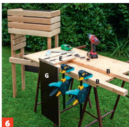
6 Rakenna keskimäinen osa samalla periaatteella kuin korkea osa. Taustalevy (G) kiinnitetään vain kahteen jalkaan (B), sillä elementin toinen pää kiinnitetään korkean osan jalkoihin (A).
