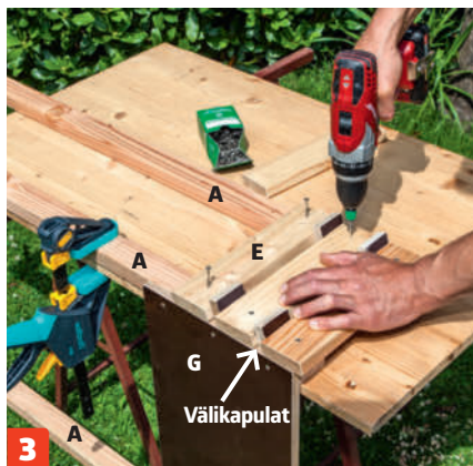
3 Käytä apuna välikapuloita, kun kiinnität rimoja (E). Se helpottaa ja nopeuttaa asentamista ja varmistaa, että rimat ovat yhtä kaukana toisistaan.
