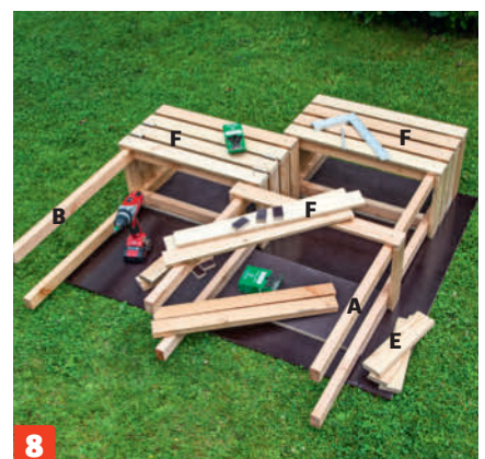
8 Asenna loput pääty- ja eturimat (E ja F) korkeaan ja keskikokoiseen osaan. Ne ovat nyt melkein valmiit. Rakenna lopuksi matala laatikko.
