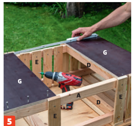
5 Mittaa, että taustalevyjen (G) väliin mahtuu neljä rimaa (E). Ruuvaa toinen taustalevy kiinni ja asenna rimat (E) laatikon toiseen pätyyn.
