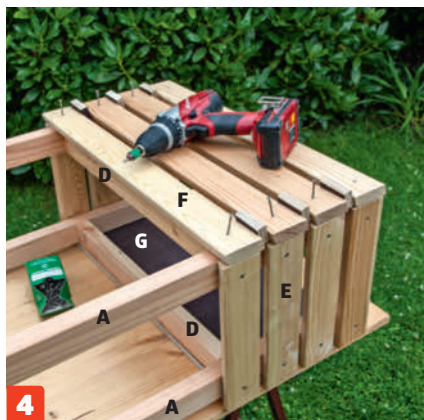
4 Kiinnitä eturimat (F), kun päätyrimat ja pohjarimat (D) ovat paikoillaan. Kiinnitä kaikki rimat (E ja F) yhdellä ruuvilla molemmista päistä.
