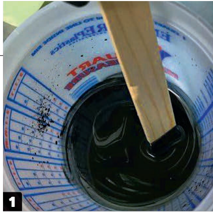
1 Sekoita väriaine epoksiin. Tässä käytetään mustaa väriä.
