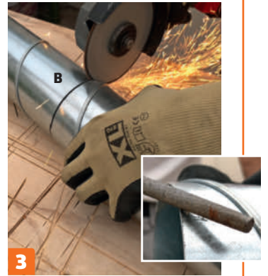
3 Sahaa putki (B) poikki kulmahiomakoneella. Pidä putki lujasti paikallaan. Viilaa teräviä reunat pois lopuksi.
