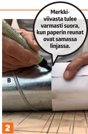
2 Taita A4-arkki putken (B) ympärille ja piirrä viiva reunaan pitkin. Jos putki on paksu, voit teipata kaksi aanelosta yhteen.
