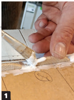
1 Sivele seinien (B) koloihin kunnolla liimaa ja paina lamellit paikoilleen. Sivele seuraavaksi liimaa lamelleihin.
