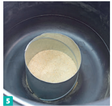
5 Vedä putkea hieman taaksepäin, jotta paljon pohja pullistuu ulospäin. Siten pöydän jalasta tulee pyöreäreunainen ja vesi valuu helposti alas.
