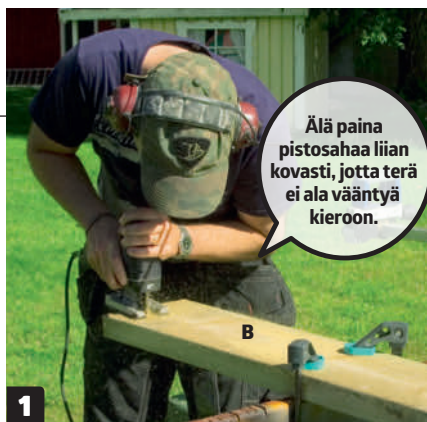
1 Sahaa poikkipuut (B) kaareviksi pistosahalla. Piirrä kaaret esimerkiksi taipuisan alumiinilistan avulla.
