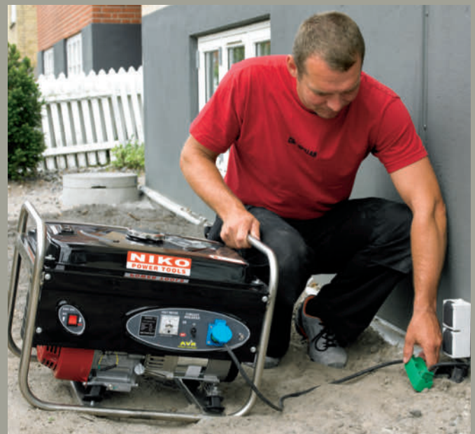
Sähkökatkon aikana voin liittää pumpun bensiinikäyttöiseen aggregaattiin.
