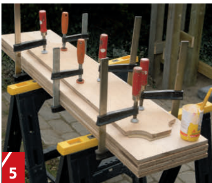
5 Koristelevyn taustaan levitetään liimaa ja se puristetaan tiukkaan peitelevyn (C) päälle. Levyt voi kiinnittää puristimilla pinoksi liiman kuivumisen ajaksi.
