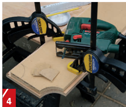
4 Koristelevyn koverat kulmat piirretään jonkin pyöreän kappaleen avulla. Levyt kiinnitetään puristimilla pinoon ja niiden kulmat sahataan samanaikaisesti.
