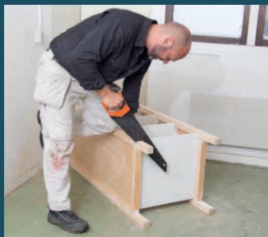
Vanhasta hyllyköstä poistetaan jalat. Hyllykkö uusiokäytetään seinähyllykönä.
