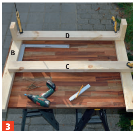
3 Aseta hyllyn etureunan osat puulevylle. Jätä poikkilautoille (G) tarpeeksi tilaa laudan (D) molempiin päihin. Voit käyttää apuna sopivan paksuisia välikapuloita.
