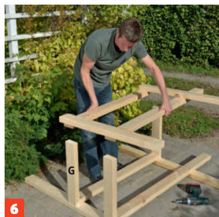
6 Aseta takareuna maata vasten ja kiinnitä kolme poikkilautaa (G) paikoilleen. Asenna etureuna paikoilleen ja kiinnitä se poikkilautoihin.
