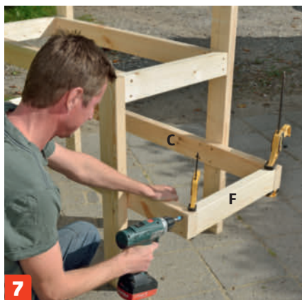
7 Kiinnitä poikkilauta (F) kahden pitkän sivun (C) väliin. Poikkilauta pysyy tarkasti oikealla paikallaan kahden puristimen avulla.
