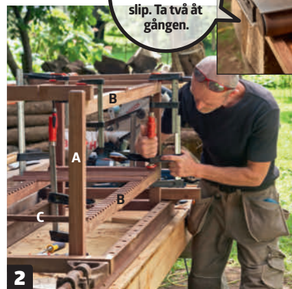
Bordet sätts i spänn. Det limmas fast ett par ribbor (C) i varje ände av bordet i topp och botten. Det säkerställer att avståndet är korrekt, och håller bordet på plats.
