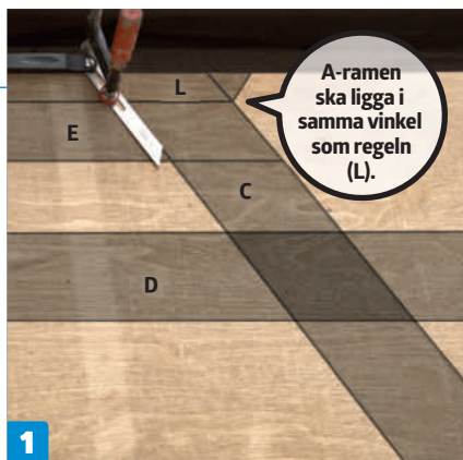
1 Mallen ritas upp i skala 1:1 på en skiva. Ben (C), tvärstag (D) och sarg (E) sågas till efter mallen.
