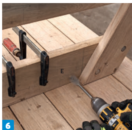
6 A-ramen görs fast i bordsskivans regler med 10 x 90 mm bultar. De försänks på bägge sidor innan de borras igenom helt.
