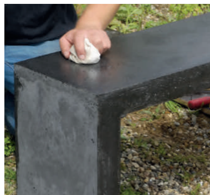
5 Avsluta med en ytbehandling med bivax. Då impregneras ytan och blir mycket smutsavvisande. Lägg på ett tunt skikt och polera in det. När bivaxet är torrt polerar du ytan med torra trasor.
