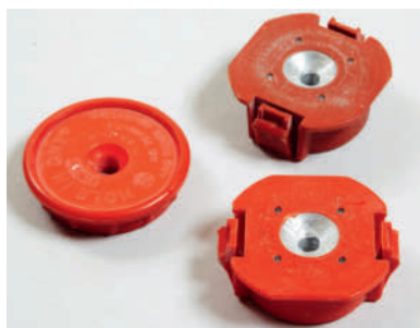
Verktyg: Magneter som du sätter i takdosorna så att du kan hitta dem när gipsskivorna är på plats. Då kan du arbeta utan att skada ångspärren.
