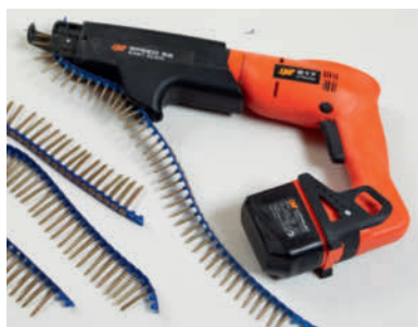
Verktyg: Gipsskruvdragare som använder skruvar på band gör det lättare att fästa skivorna. Köp annars djupstopp för gipsmontering.
