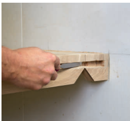
Handöverfräsens parallellanslag ställs så att noten fräses på en höjd som passar pluggarna.
