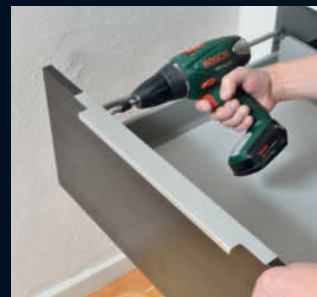
Lådhandtagen skruvas fast på lådframstyckena från baksidan.
