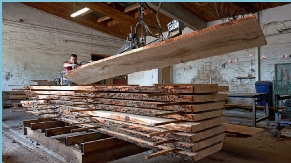
Så snart man har sågat ut en plank ur en stam lyfts plankan upp med en vakuumlift och staplas sedan ovanpå andra likadana plankor.
