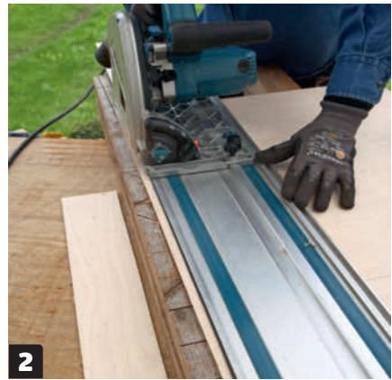
**Strek opp formen til vasken** på et stykke kryssfinér (legg til cirka 2 mm rundt hele). Kanten på denne vasken er 4 mm tykk, så det samme er kryssfinérplaten.
