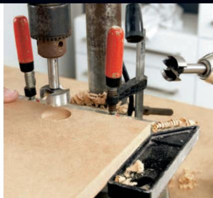
**1** Hullene til hengslene børes med søyleboremaskin eller med en alminnelig boremaskin, helst i stativ, med et sylinderbor (kvistbor) i passende størrelse.
