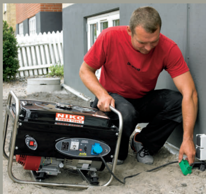
Blir strømmen brutt på det offentlige strømnettet, kan jeg koble pumpa til en bensindrevet nødstrømsgenerator.
