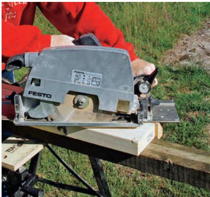
**3** Den vannrette delen (undergurten) (B) tilpasses med ei sirkelsag fordi den ikke kan sages med ei gjærssag. Skru ei føringssskinne på ei lekt med ei skrutvinge slik at den sitter i en vinkel på 27 grader.
