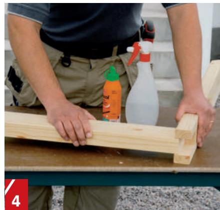
**4 Montér delene (A) og (B) med PU-lim**, det er sterkt og utfyller ujevnheter. Delene må ikke være for trange når de monteres – da risikerer du at det sprekker ved hakket. Legg lim på den ene flata, og montér delene.
