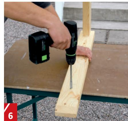
**Bor opp til de franske skruene** som den loddrette delen (A) skal festes i veggen med. Lag et hull ca. 20 cm ovenfra og et ca. 17 cm nedenfra med et 12 mm trebor.
