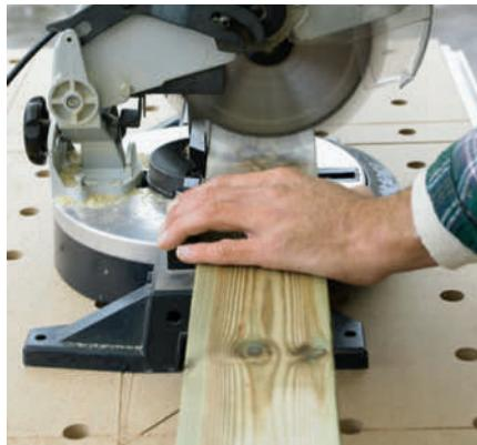
**4 Sag ut de seks tverrbordene (N)** slik at de passer mellom de loddrette bordene (M), og sag bordene (O) slik at de er lik avstanden mellom tverrbordene (F) i stakitten pluss 90 mm.
