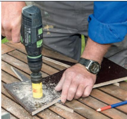
**1** Bor et hull i hver ende av alle håndtak; i de to sidene (D) og setet (A). Bruk en 32 mm hullsag. For å få glatte kanter, borer du først fra den ene siden, til senterboret er kommet gjennom, men bare slik at sagbladet er halvveis gjennom.
