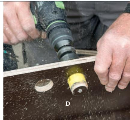
**2** Snu platen, og bor fra den andre siden. Senterboret stikkes ned i hullet du boret fra den andre siden, og styrer sagbladet på plass. **TIPS:** En hullsag på 32 mm er lettest å styre hvis du kjører med høy hastighet.
