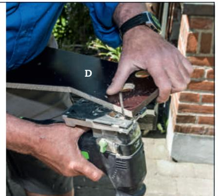
**5** Hjørnene rundes på sidene (D) og hyllen (C). Rundingen markeres f.eks. med korken fra en flaske med en diameter på 2-3 cm. Sag sakte, så snittet ikke flises opp. På hyllen (C) fjernes de to bakerste hjørnene, så regnvannet kan renne unna.
