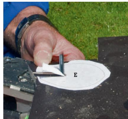
**4** Føttene (E) sager vi også ut med stikksagen. Vi limer en printet mal av den foten vi har valgt på en platestump. Vi lager fire like føtter – to av dem vendes omvendt når vi skrur dem fast på sidene, slik at de blir både venstre og høyre fot.
