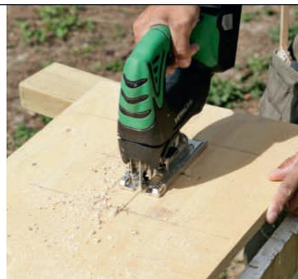
**2 Sag ut hullet etter de ytterste strekene.** Bruk en stikksag, og slip hullet rent med slipepapir.
