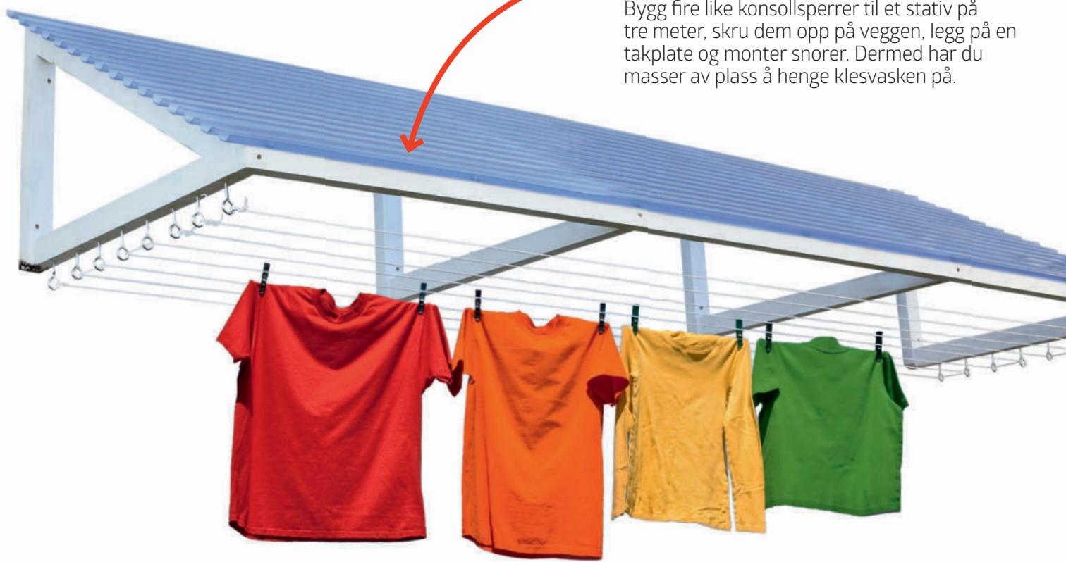
Bygg fire like konsollsperre til et stativ på tre meter, skru dem opp på veggen, legg på en takplate og monter snorer. Dermed har du masser av plass å henge klesvasken på.
