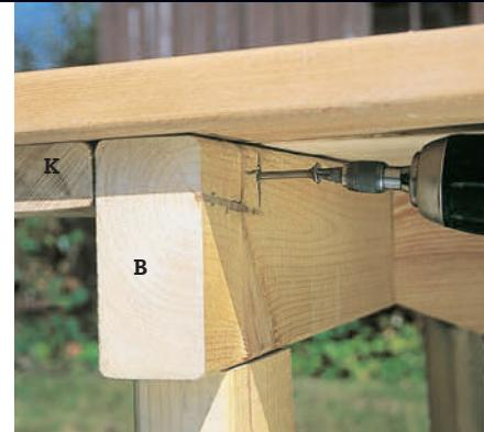
**3** Skru fast bordplata til understellet med fire skruer gjennom overliggeren (B) og inn i tverrliggeren (K) under bordet.
