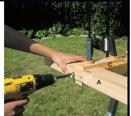
**2 Hold bein (A) og tverravstiver (C) sammen** med et par lister og tvinger midt på beinet. Med et 16 mm spiralbor borer du 20 cm dype hull til to plagger (D). Hullene skal ligge 15 mm innenfor ytterkantene på tverravstiveren.
