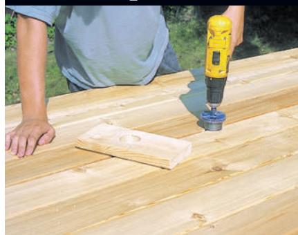
**1** Akkurat midt på bordet borer du et hull som passer til parasollen. Begynn med å bore et hull i en bordbit, og bruk den som boreguide til å styre hullsaga etter den første centimeteren.
