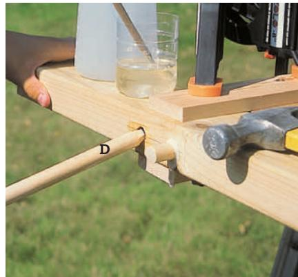
**3 Sag ut 25 cm lange biter av en 16 mm rundstokk, og spiss dem** lett med en kniv. Kanten av hullet og rundstokkene (pluggene) smøres med et tynt lag PU-lim (polyuretan) før de slås inn.
