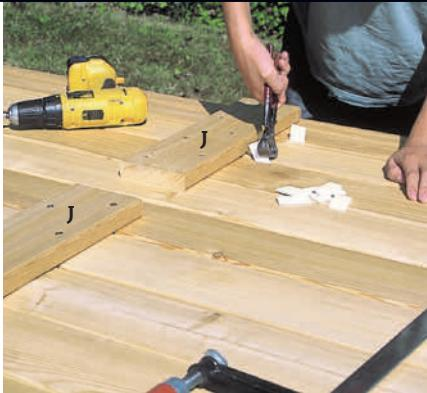
**2** Den midterste tverrliggeren (J) sager du av på midten slik at det er plass til bordene (F) oppe under bordet. Avstandsbrikkene fjernes med ei tang.
