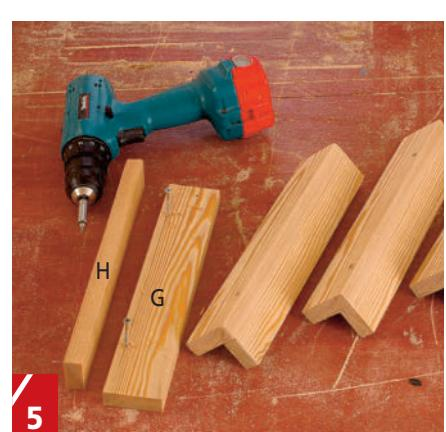
**5** **Lag hjørnelistene (G og H)** av 16 x 98 mm glattkant som deles til to lister på 55 og 40 mm. De skal være 30 cm lange. Montér listene med PU-lim og tre 4 x 40 mm skruer slik at du får fire 90 grader hjørnelister.
