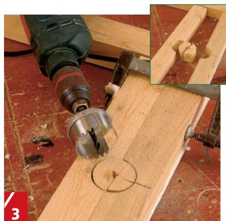
**Sag et hakk på innsiden** av beina til ramma. Det er nødvendig for at den kan gå inn over kantlistene på kassa. Du kan for eksempel spenne fast ei hjelplist til ramma og sage ett hull med ei hullsag. Har du ikke det, kan ei stikksag også klare oppgaven.
